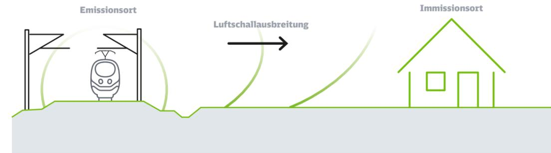
Es ist unvermeidlich, dass beim Rollen von Rädern auf den Schienen Schall entsteht. Der Kontakt führt insbesondere bei den vorhandenen Rauheiten zu Schwingungen, die von Rad und Schiene in Form von Luftschall in die Umgebung abgestrahlt werden.
