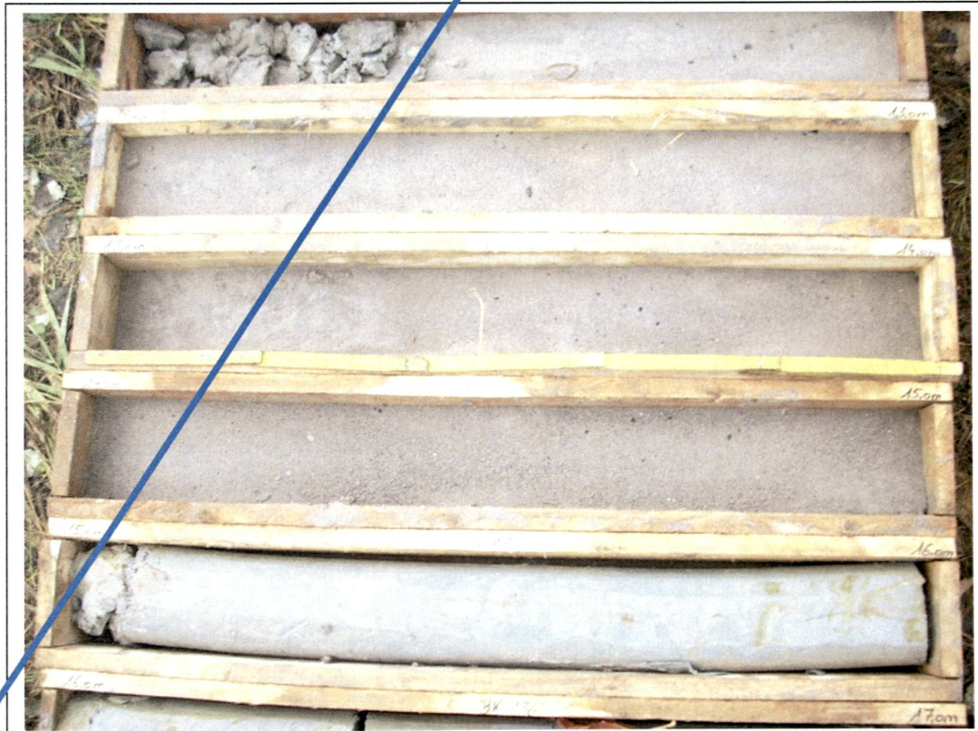
Bild 6. Bohrung S/B 96: 12,0 - 16,0 m
