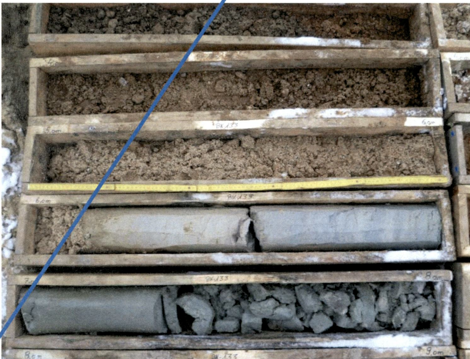
Bild 10. Bohrung B 133: 4,00 - 8,00 m
