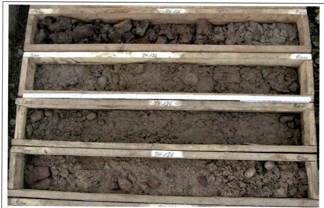
Bild 7. Bohrung S/B 126: 4,0 - 8,0 m
