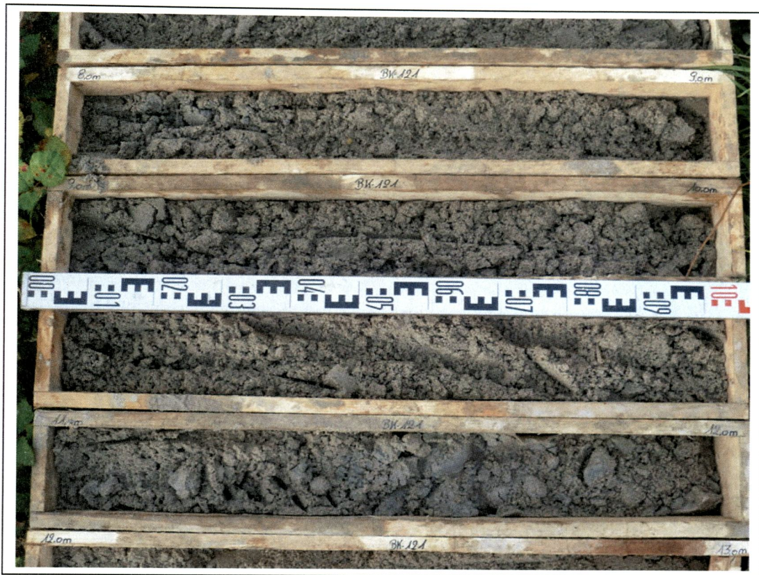
Bild 17. Bohrung S/B 121: 8,0 - 12,0 m
