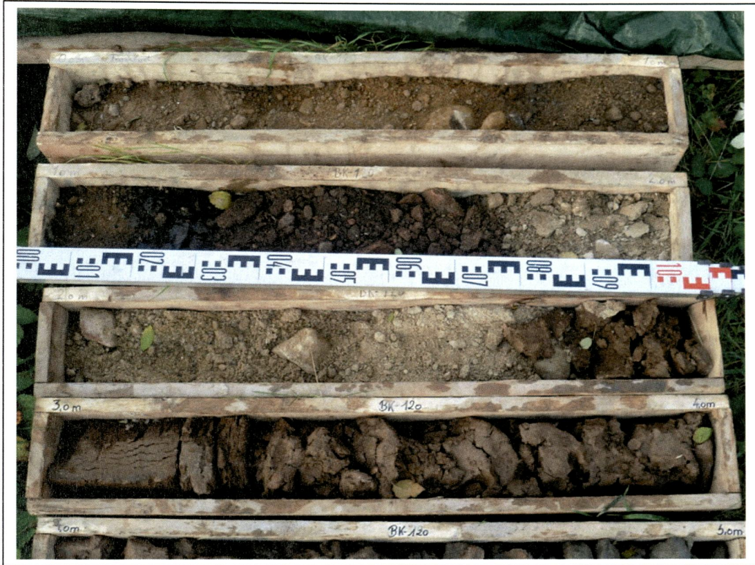
Bild 7. Bohrung S/B 120: 0,0 - 4,0 m
