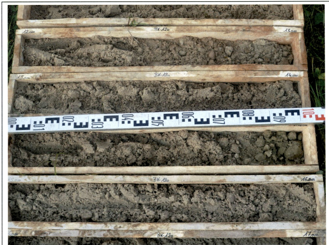
Bild 10. Bohrung S/B 120: 12,0 - 16,0 m
