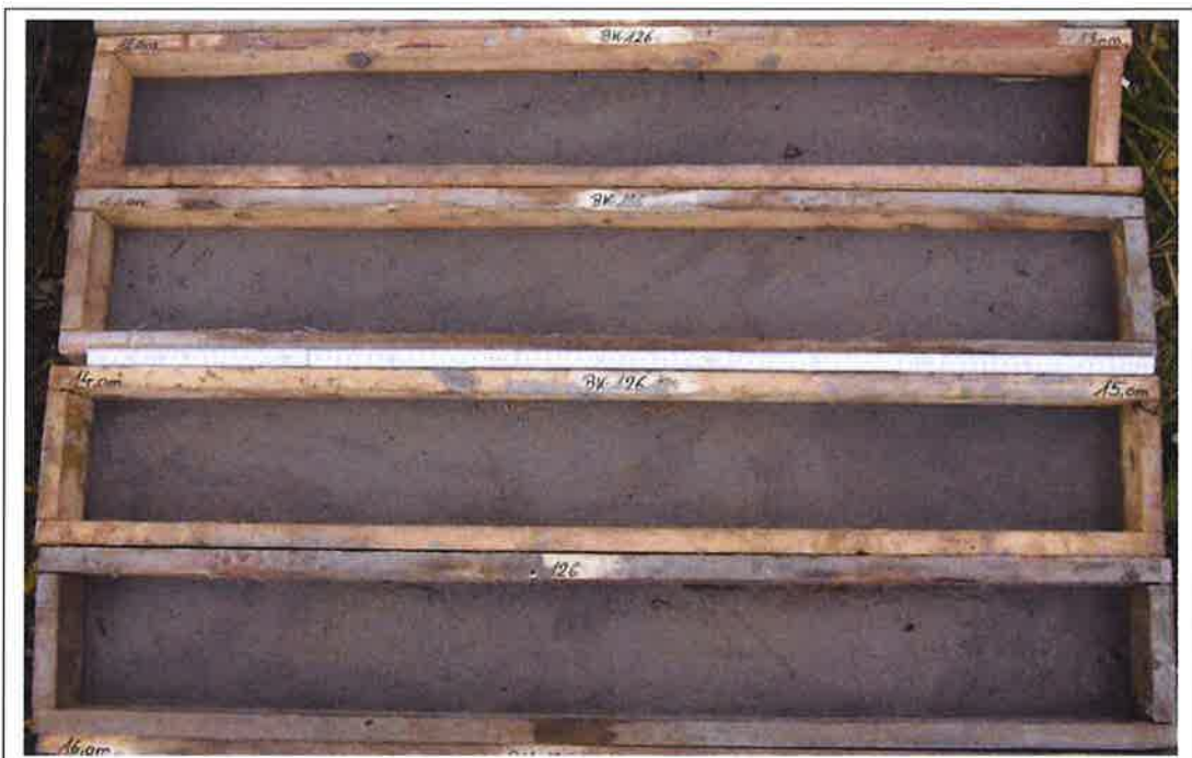
Bild 17. Bohrung S/B 126: 12,0 - 16,0 m
