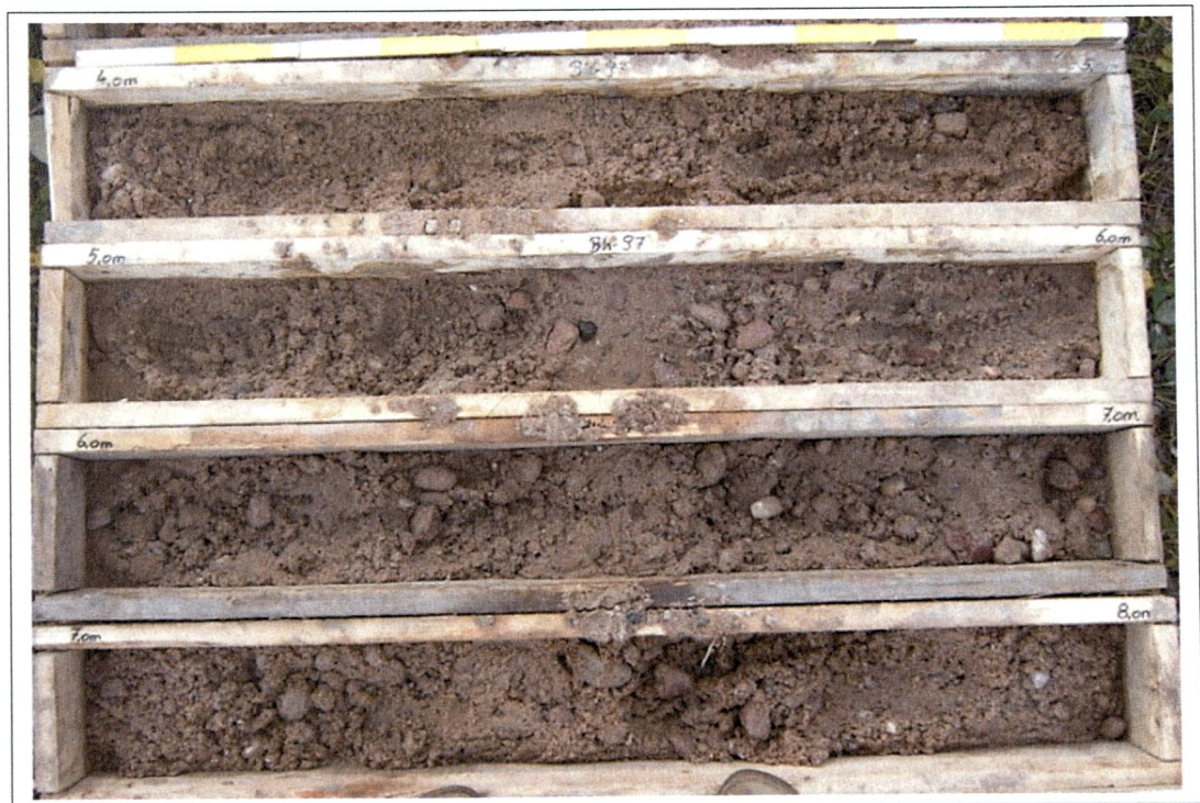
Bild 10. Bohrung S/B 97: 4,0 - 8,0 m
