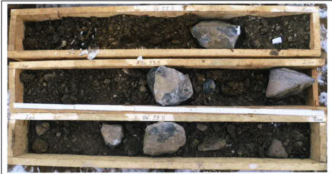
Bild 3. Bohrung S/B 53b: 0,0 - 3,0 m (abgebrochen bei 3 m!)
